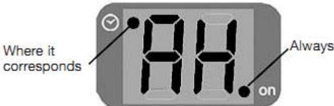
Όταν αυτή η λειτουργία αυτή είναι ενεργοποιημένη, η συσκευή ενεργοποιείται όταν η θερμοκρασία πέσει στους 5°C, διατηρώντας τη θερμοκρασία μεταξύ 5°C και 6°C.
