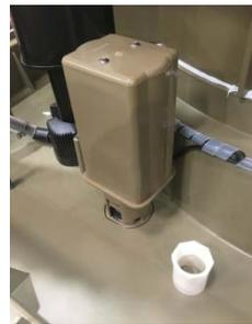
Válvula de descarga montada
