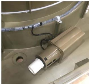
Válvula de descarga sin montar
