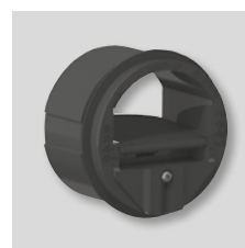
RDR Ρυθμιζόμενο διάφραγμα (50-250 Pa), που τοποθετείται μέσα στον αγωγό και διατηρεί σταθερή την ροή του αέρα.
