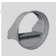
RD BP Ειδικό διάφραγμα χαμηλής πίεσης (20-100 Pa), ρυθμιζόμενο, με σύνδεσμο για να χωράει απευθείας στον αγωγό. Με διάμετρο 80 mm. Ροή αέρα: 15 ή 30 m 3 /h.
