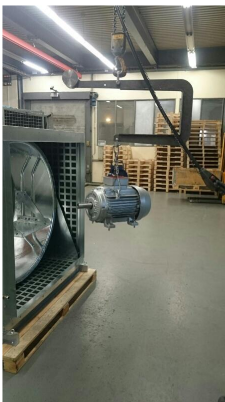
Fig 21 Type de levage pour moteur dans virole longue
