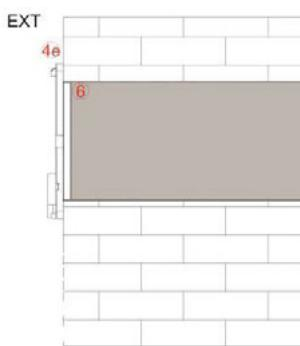
Insérez le diamètre de centrage de la fixation murale (4e) dans le tube intégré (6).
