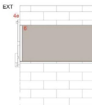
Plaats de centreerdiameter van de muurbevestiging (4e) in de geïntegreerde buis (6).
